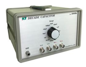
本器は四端子測定にて、1 pF~100µFの静電容量を設定すること が出来る可変コンデンサです。精度及び安定性も非常に優れている為、 LCRメータの校正用標準器として使用出来ます。
