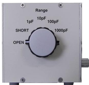
VACシリーズは、4端子構造で内蔵するコンデンサの静電容量・損失係数を1pF～1μF間で下記の仕様の範囲で自由に10個まで選択ができる標準コンデンサです。OPEN・SHROTLレンジを標準で装備しておりますのでケーブルを接続したままで補正が可能です。安定性も非常に優れている為、LCRメータの校正用標準器としても使用出来ます。
