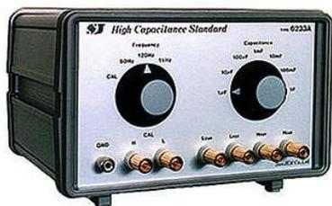
本器は、高性能コンデンサと精密変成器とを組合せ、等価的に1Fまでの大容量を得る事の出来る4端子大容量標準コンデンサです。1 $\mu$ F～1 Fの静電容量が設定出来（6230A においては1/10ステップでの可変も可能）精度及び安定性も非常に優れている為、LCRメータの校正用標準器としても使用出来ます。
