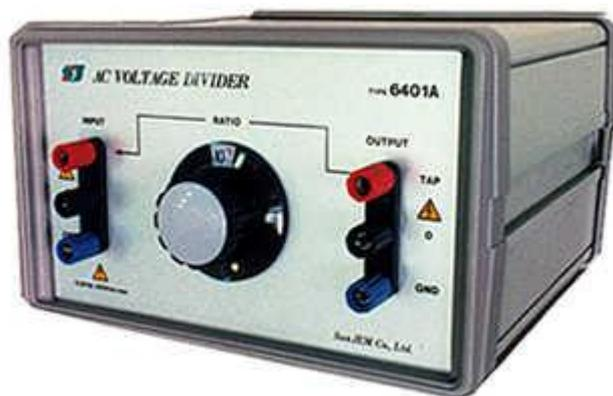
本器は、交流電圧の校正作業において、校正器では出力できない微小電圧を校正器と組み合わせて、高精度で出力します。
