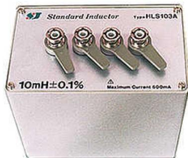
本器は、LCRメータ校正用4端子構造の固定形標準インダクタです。従来の標準インダクタよりも、小型、軽量化してありますので常用標準として最適です。BNC構造となっている為、LCRメータへ直接接続が出来ます。相互誘導器標準器も製作可能ですのでご相談ください。
