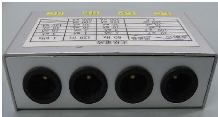
四端子型LCRメータのバイディングポストタイプのコネクタをBNCに変換するアダプタです。
