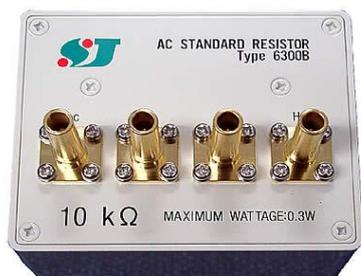
本器は、(独)産業技術総合研究所 計量標準総合センター (NMIJ/AIST) において技術指導を仰ぎ設計したもので、10 kHz以下の周波数においてAC-DC誤差が10ppm以下、位相角誤差が50 $\mu$ rad以下を実現した精密交流抵抗器です。
